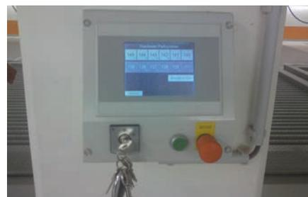
Touch-Screen mit Schlüsselschalter und Not-Aus im Totmannsteuerung.
