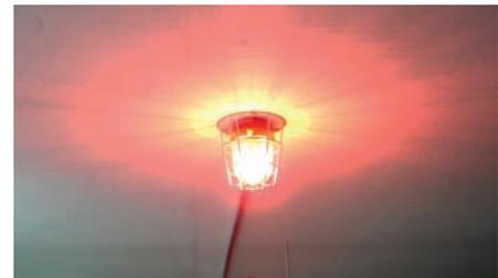
Die Blitzleuchte signalisiert dass die Anlage in Betrieb ist und gibt somit dem Nutzer sowohl den Leuten in der Nähe der Anlage mehrere Sicherheit beim Benutzen. Eine Blitzleuchte kann bis für 2 Anlagen benutzt werden.
